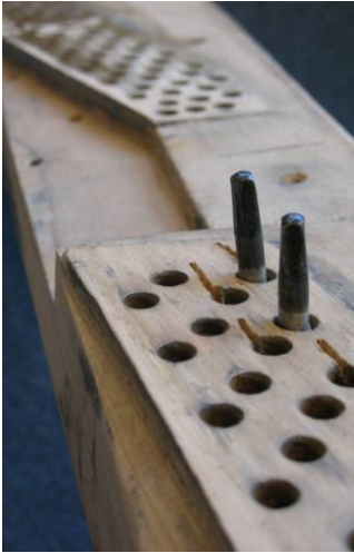
gescheurd stemblok met stempennen
